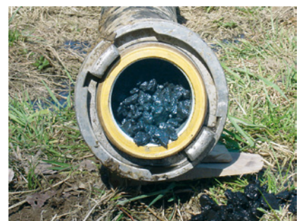
Grobe Inkrustierungsfragmente, die sich durch ihre besondere Härte nicht kleiner zerreiben liessen.
